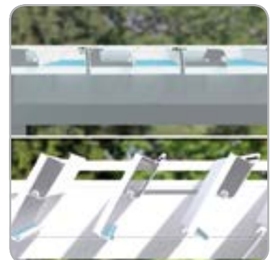
Desagüe controlado cuando se abren las lamas
